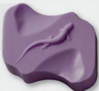
Elastomerový blok s ještěrkou je tlumič segment sedlovky Cane Creek Thud Buster ST s kratším zdvihem 33 mm. Podle barvy se odlišuje tvrdost elastomeru v závislosti na váze jezdce.
