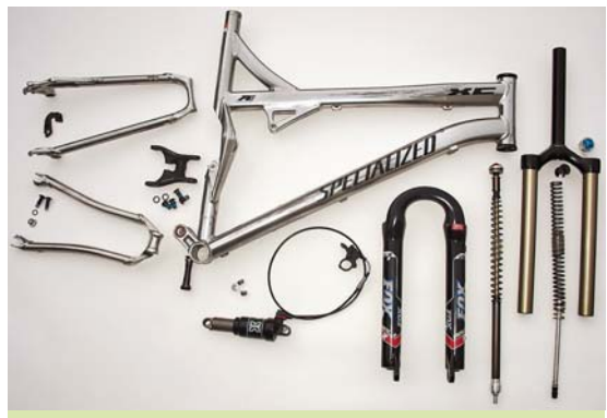
Zdá se to jen jako minimum dílů, které tvoří celoodpružený rám a rovněží i vidlici, ovšem všechno pečlivě rozebrat, vyčistit, vyměnit ložiska a opět důkladně poskládat, to jsou skoro dva dny práce, protože k tomu musíme přičíst i odstavení a nastavení dílů.
