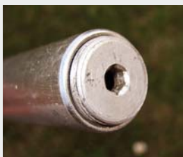
Víčko vnější trubky je na závit a jeho šroubováním dovnitř sedlovky lze přitvrdit pružinu a přizpůsobit tak sedlovku váze jezdce.
