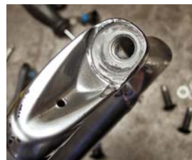
Sedlová vzpěra na straně s poškozeným ložiskem přišla o část materiálu kolem podložky mezi ložiskem a kyvkou. Ten se vlivem pohybu podložky kvůli vyspanému ložisku prostě vymačkala.
