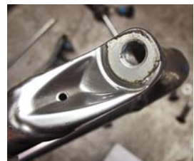
Původní stav vzpěry, když bylo ložisko v pořádku. Jako příklad jsme použili druhou stranu vzpěry, kde ložisko vydrželo.
