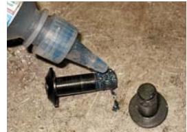
Při konečné montáži všech dílů rámu dohromady je nutné použít závitový tmel, aby se šrouby čepů samy nepovolily. Tmel také zajistí snadnější demontáž, protože materiál díky němu nesrůstá.
